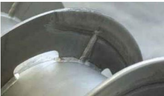
Hình 5. Bảo vệ chống mài mòn cánh vít bằng cách phủ phun tungsten carbide
