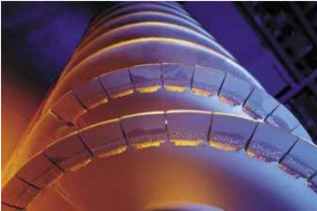
Hình 4. Các tấm hàn tungsten carbide bảo vệ cánh vít tải.
